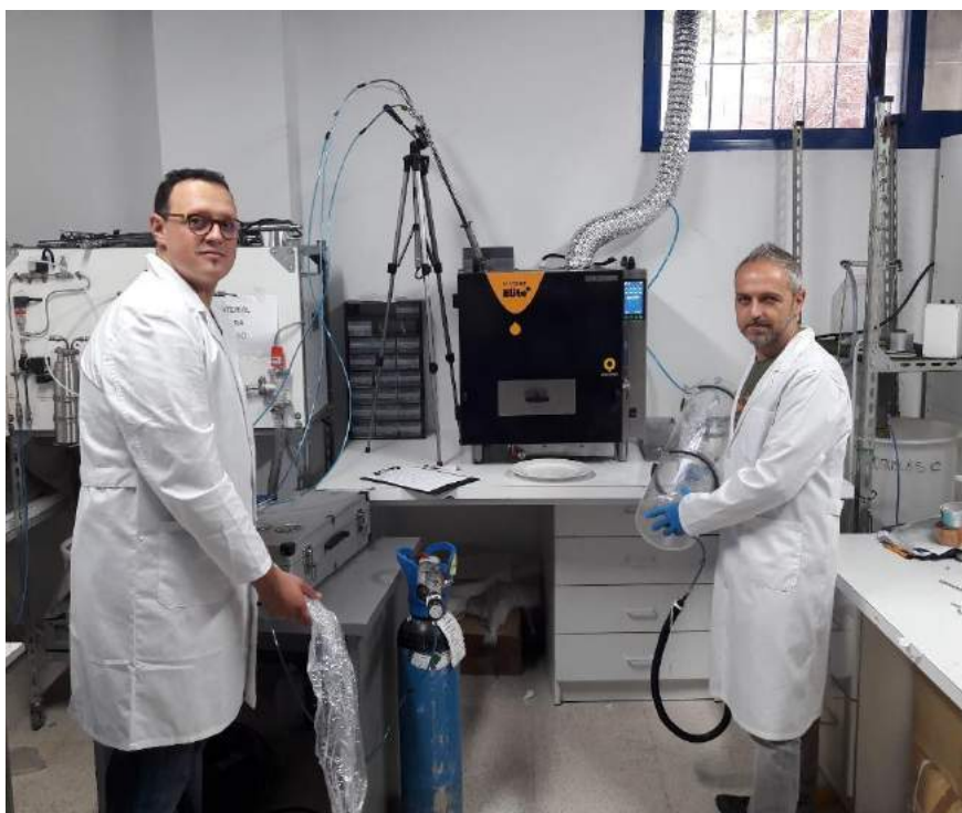
Fotografía II.2. Toma de muestras, con el método de la sonda, entrada-salida simultánea del sistema de desodorización incorporado en la FAST CHEF Elite+ Fryer.
